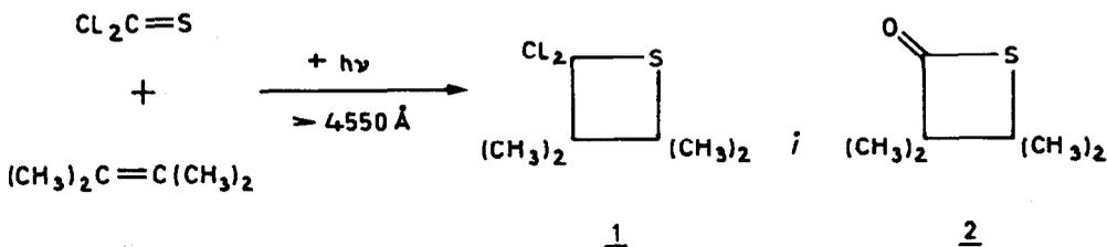
Belichtet man die entgaste benzolische Lösung aus Thiophosgen (0.126 m) und 2.3-Dimethyl-buten-(2) (0.245 m) mit einem 450 W Hanovia Quecksilber-Mitteldruckbrenner unter Verwendung eines Natriumchromat-Filters (0.04 m,  $d=0.5 \text{ cm}$ ), so gelangt man zu 51% 2.2-Dichlor-3.3.4.4-tetramethyl-thietan (1, Öl). 1 zeigt im  $^1\text{H-NMR}$ -Spektrum <sup>7</sup> zwei Methylsingulets bei  $\tau 8.60$  und  $1221$
